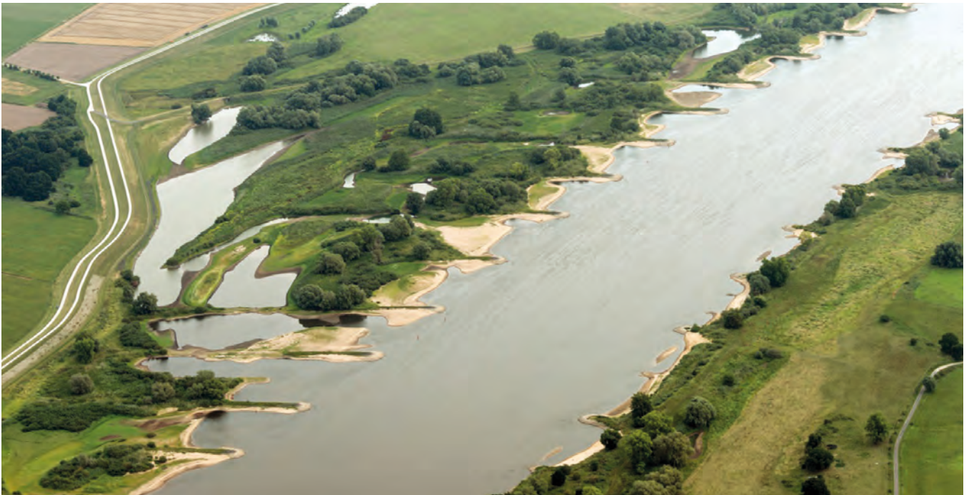
Abbildung 10: Sedimentablagerungen im Bereich der Bühnenfelder und im Deichvorland im Bereich Neu Wendischthun
