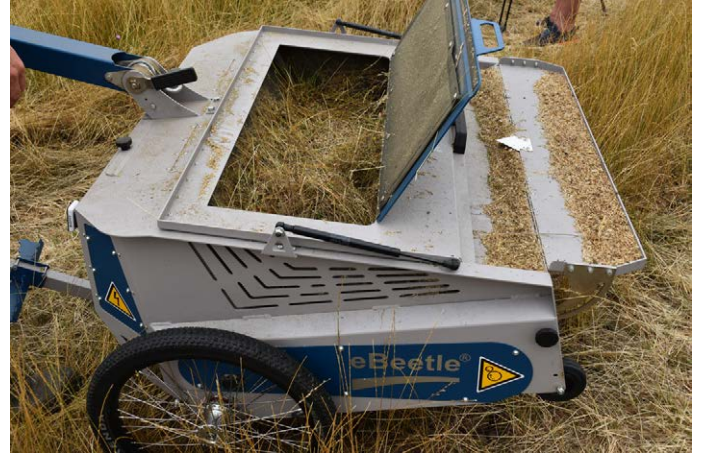
Abb. 5: Zur Samensammlung insbesondere auf niedrigwüchsigen Spenderflächen wie Borstgrasrasen bietet sich das Aufbürsten der Samen mit einem „Seedharvester“ an. Die gleiche Fläche kann zu mehreren Zeiten im Jahr (Früh- und Spätblüher) beerntet werden. (Foto: SICONA)
