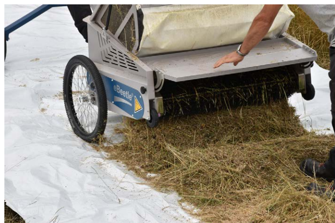
Abb. 15: Bei der Wiederherstellung von Magerrasen bietet der Einsatz einer Ausbürstmaschine große Vorteile. (Foto: SICONA)
