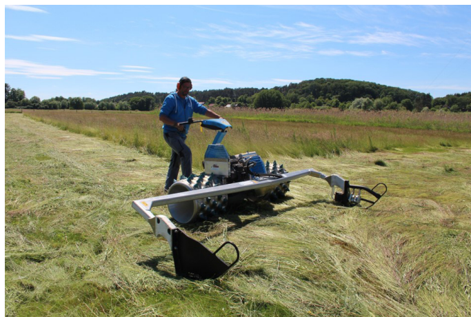
Abb. 3: Selbstfahrender Einachsmäher mit Doppelmesserbalken sowie Stachelwalzenrädern zur Schonung von Boden und Fauna (Foto: O. Schwarzer)
