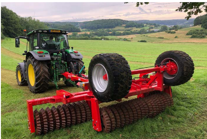
Abb. 8: Nach der Mahdgutübertragung oder Ansaat sollte durch den Einsatz einer Walze ein guter Bodenkontakt der Samen hergestellt werden. (Foto: SICONA)
