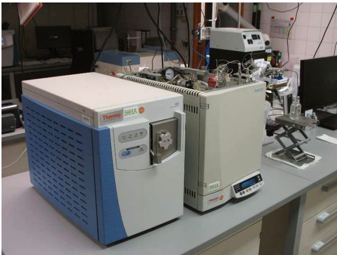
Bild 3: Analytik zur Messung von molekularem Stickstoff (N 2 ) und Argon (Ar)
