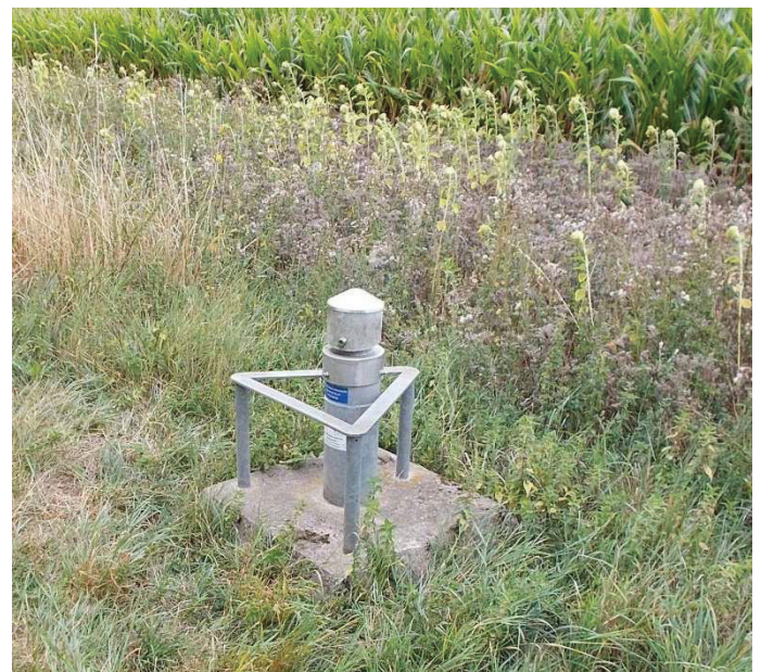
Bild 2: Grundwassermessstelle im Landkreis Göttingen
