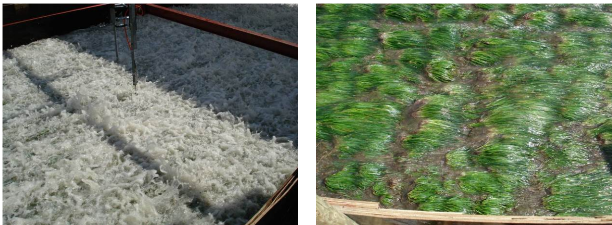
Abb. 2.1: Kleiabdeckung und Grasnarbe des Versuchsdeichs in Delfzijl (hier bei 50 \text{ l}/(\text{s}\cdot\text{m}) mittlerer Wellenüberlauftrate)
