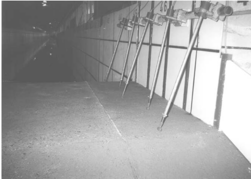
Abb. 5.52: Position der Strömungspropeller auf der Deichkrone (Oumeraci et al., 2001)
