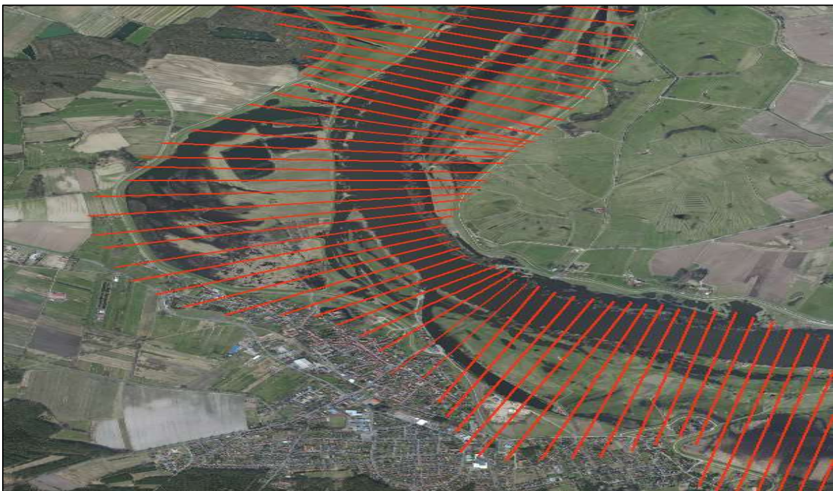
Abb. 3.2: Ausschnitt aus HEC-GeoRAS mit festgelegten Querprofilagen (Elbe-km 350 bis Elbe-km 360)
