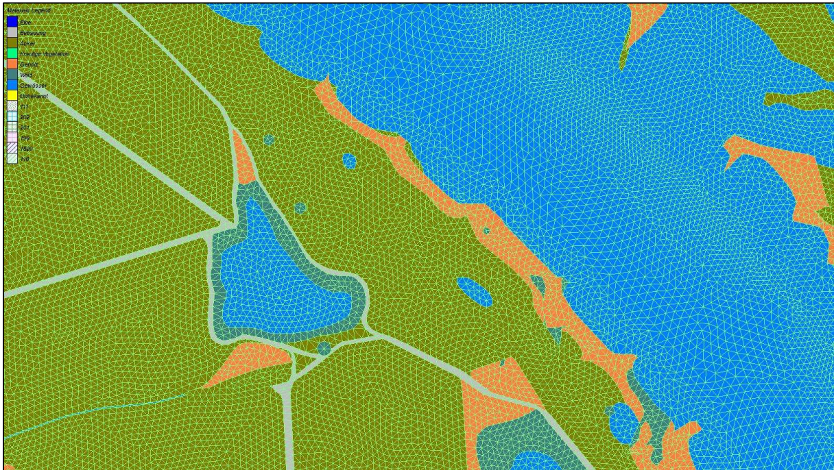
Abb. 3.6: Ausschnitt aus dem Berechnungsgitter im Bereich Elbe-km 557
