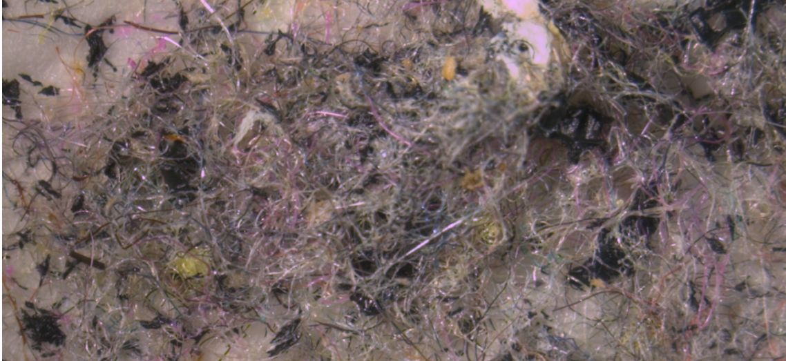
Abbildung 13: Mikroskopische Aufnahme (10-fache Vergrößerung) von Faserrückständen aus der Waschlade nach dem Waschen einer Waschlade Trikots aus Polyester
