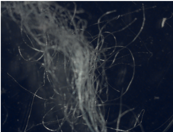
Abbildung 3: Mikroskopische Aufnahme (10-fach) von Polyacrylnitril-Fasern (Strickjacke)
