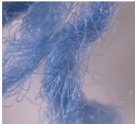
Abbildung 4: Mikroskopische Aufnahme (35-fach) eines Baumwollfadens (Handtuch)
