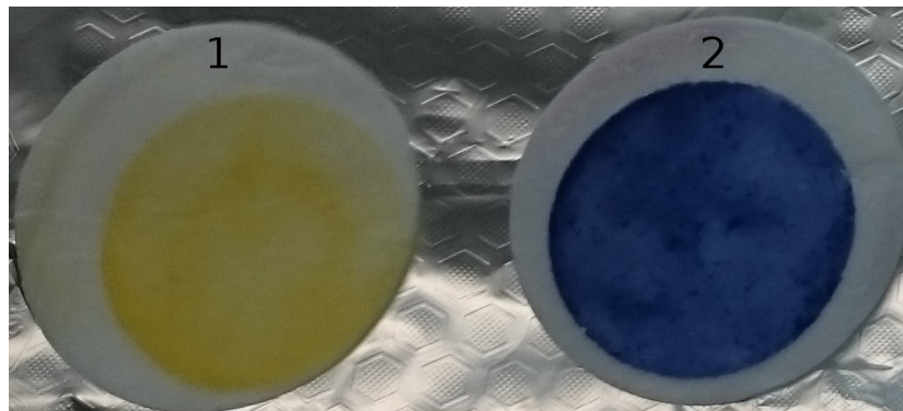
Abbildung 10: Filtrerrückstand von Baumwollproben nach 24 Stunden Behandlung mit Schwefelsäure (40%) bei 40°C (1 – gelbes T-Shirt; 2 – blaues Handtuch)
