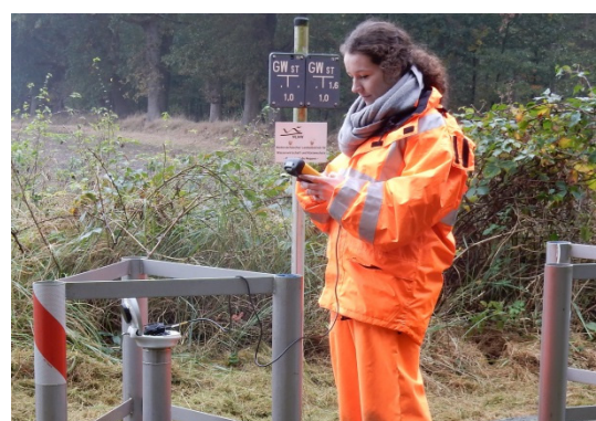
Abb. 41: Überprüfung der DFÜ-Sonde.
