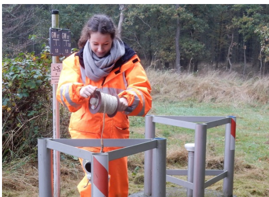
Abb. 40: Grundwasserstandsmessung mit dem Lichtlot.
