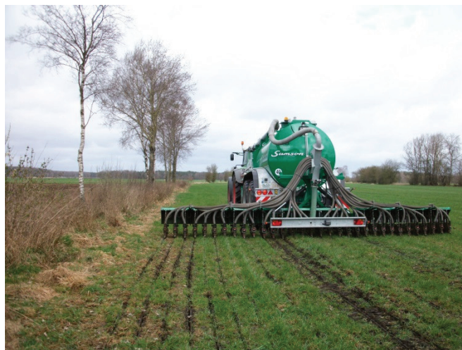
Demonstration zur gewässerschonenden Gülleausbringung mittels Injektion. Durch die Einbringung des Wirtschaftsdüngers direkt in den Boden werden Verluste durch Ausgasung und Abschwemmung verhindert.
