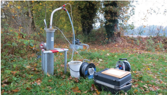
Beprobung der Grundwassermessstelle Messstelle Collinghorst im Dienstgebiet der NLWKN-Betriebsstelle Aurich
