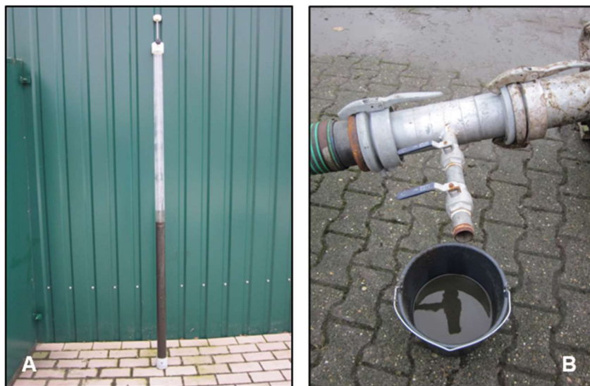
Abb. 1. Probensonde (2 m Länge, 0,53 mm ID) für die repräsentative Entnahme von Gülleproben aus Güllekellern (A) sowie Bypass-Sammler während der Befüllung eines Vakuumtankwagens (B) (Kreuzig et al., 2016).
