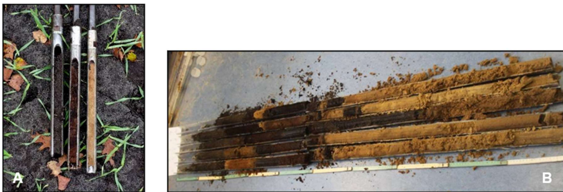
Abb. 2. Entnahme von Bodenproben aus dem Tiefenprofil: N_{min} -Bohrstocksystem für 0-30, 30-60 und 60-90 cm-Bodentiefe (A) sowie Rammkernsondierung für 0-100 und 100-200 cm-Bodentiefe (B) (Zellmann, 2020).
