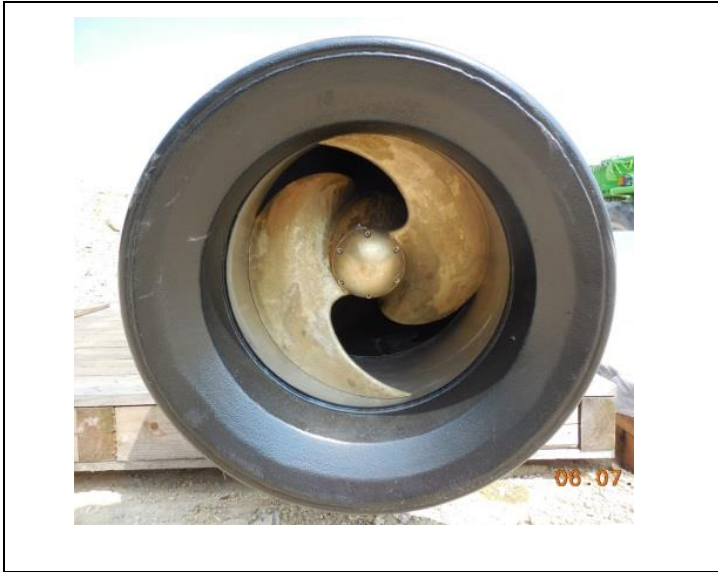
Abb. 6: Impeller einer fischschonenden Pentair-Pumpe (Foto: S. Balzar RMD Wasserstraßen GmbH).
