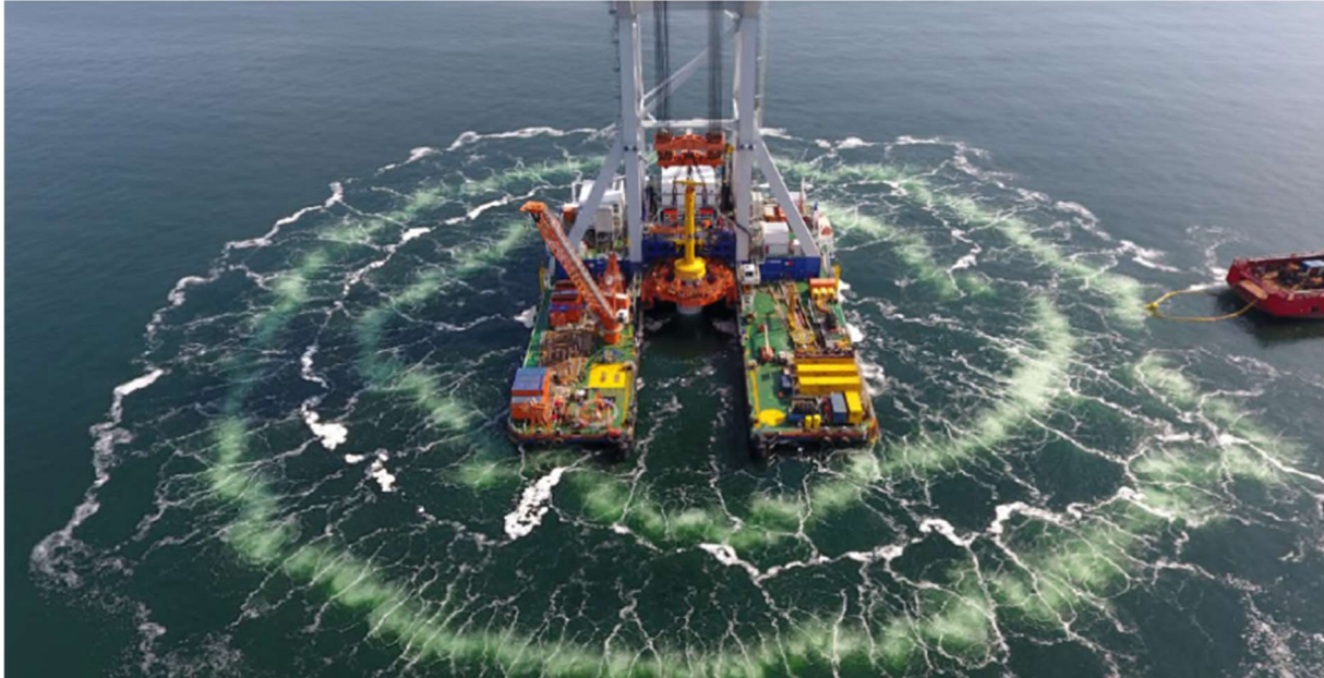
Abbildung 67: Beispiel 1 Schallminderungsmaßnahme Druckluftblasenvorhang
