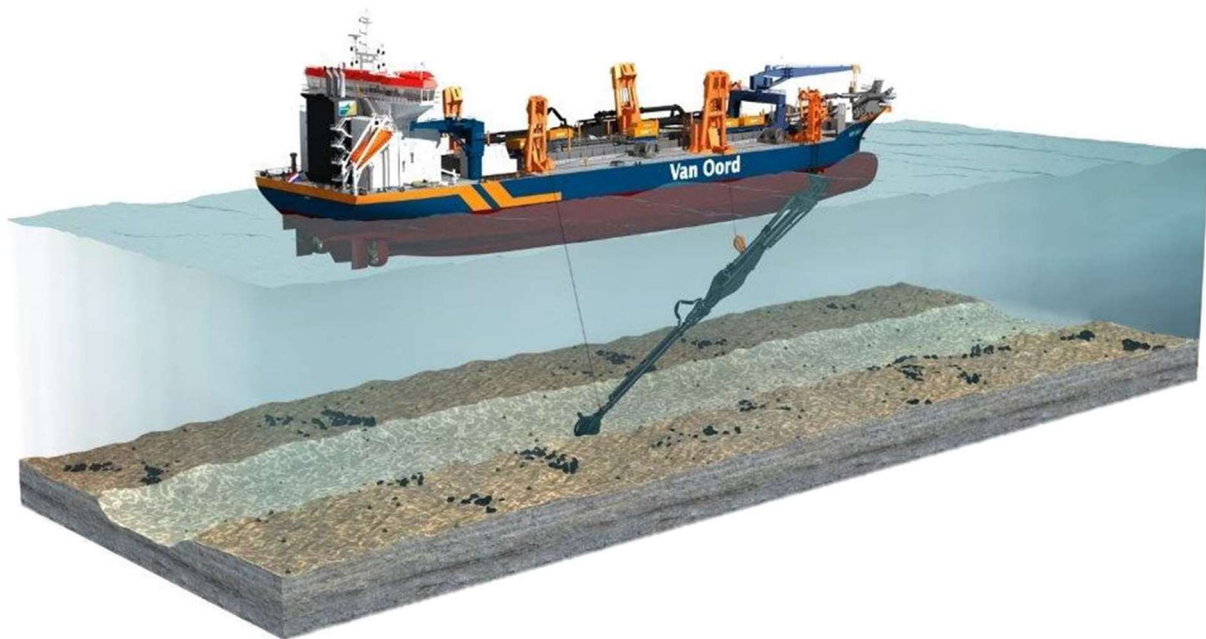
Abbildung 23: Arbeitsschiff zum Herstellen der Liegewanne und des Zufahrtbereiches (Beispiel)
