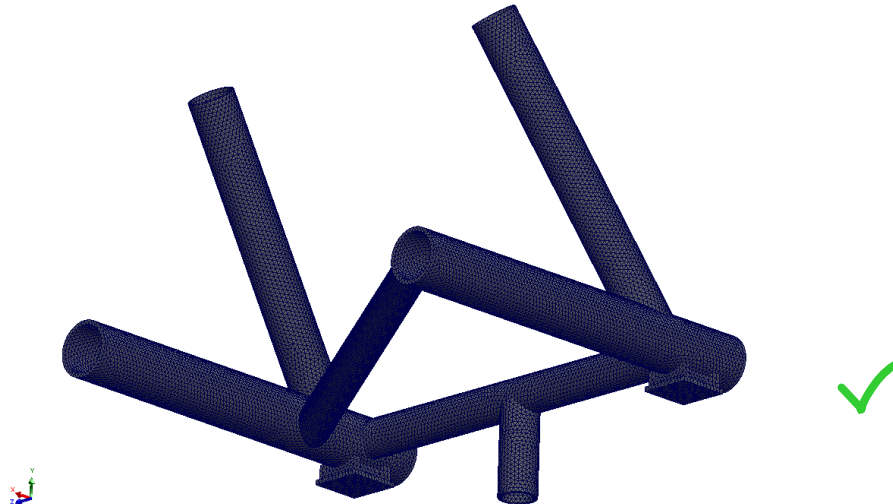
Abbildung 12-6: FE-Netz - Detailmodell der Brückenlager
