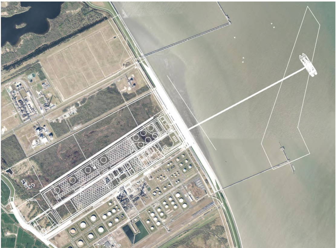
Abbildung 3-1: Schematische Darstellung des geplanten Terminals mit den landseitigen Speicher- und Aufbereitungsanlagen im Südwesten und dem Schiffsanleger im Nordosten
