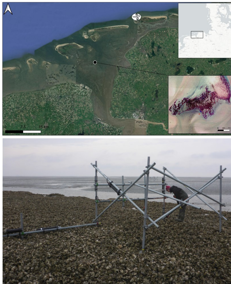
Abbildung 34: Oben: Standort der Messstationen im Ostfriesischen Wattenmeer. Windsymbol: Standort der DWD-Messstation auf Norderney. Foto des Messrahmens auf der Muschelbank mit Geräten, im Hintergrund der Rahmen auf der Sandbank (Foto: NLPV)
