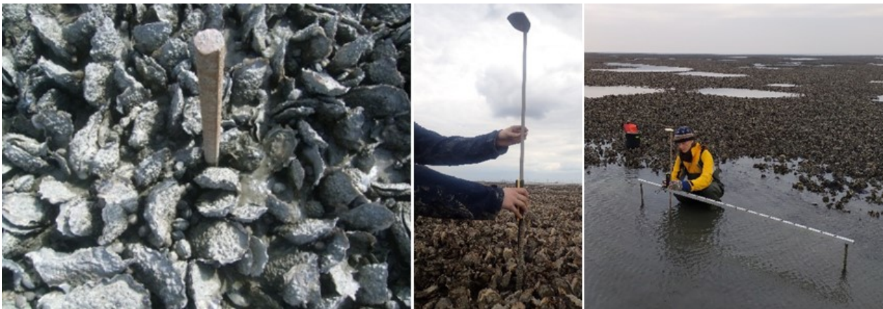
Abbildung 6: Messung von Sedimentauftrag und -abtrag mit einer Sedimentation-Erosions-Stange (SES; links und Mitte) und einem Sedimentation-Erosions-Balken (SEB; rechts).
