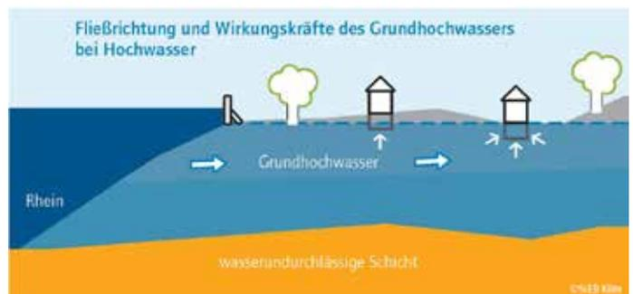
Abb 2b: Fließrichtung und Wirkungskräfte des Grundhochwassers bei Hochwasser (StEB Köln)
