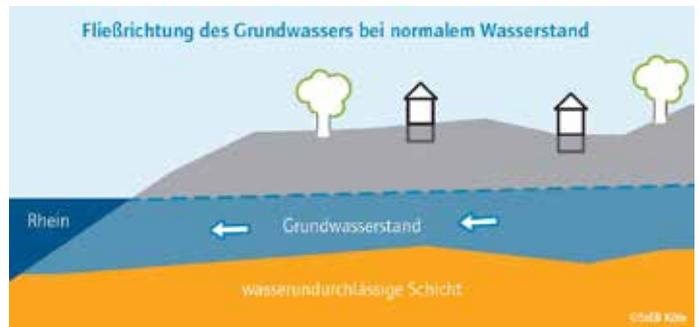
Abb 2a: Fließrichtung des Grundwassers bei normalem Wasserstand (StEB Köln)
