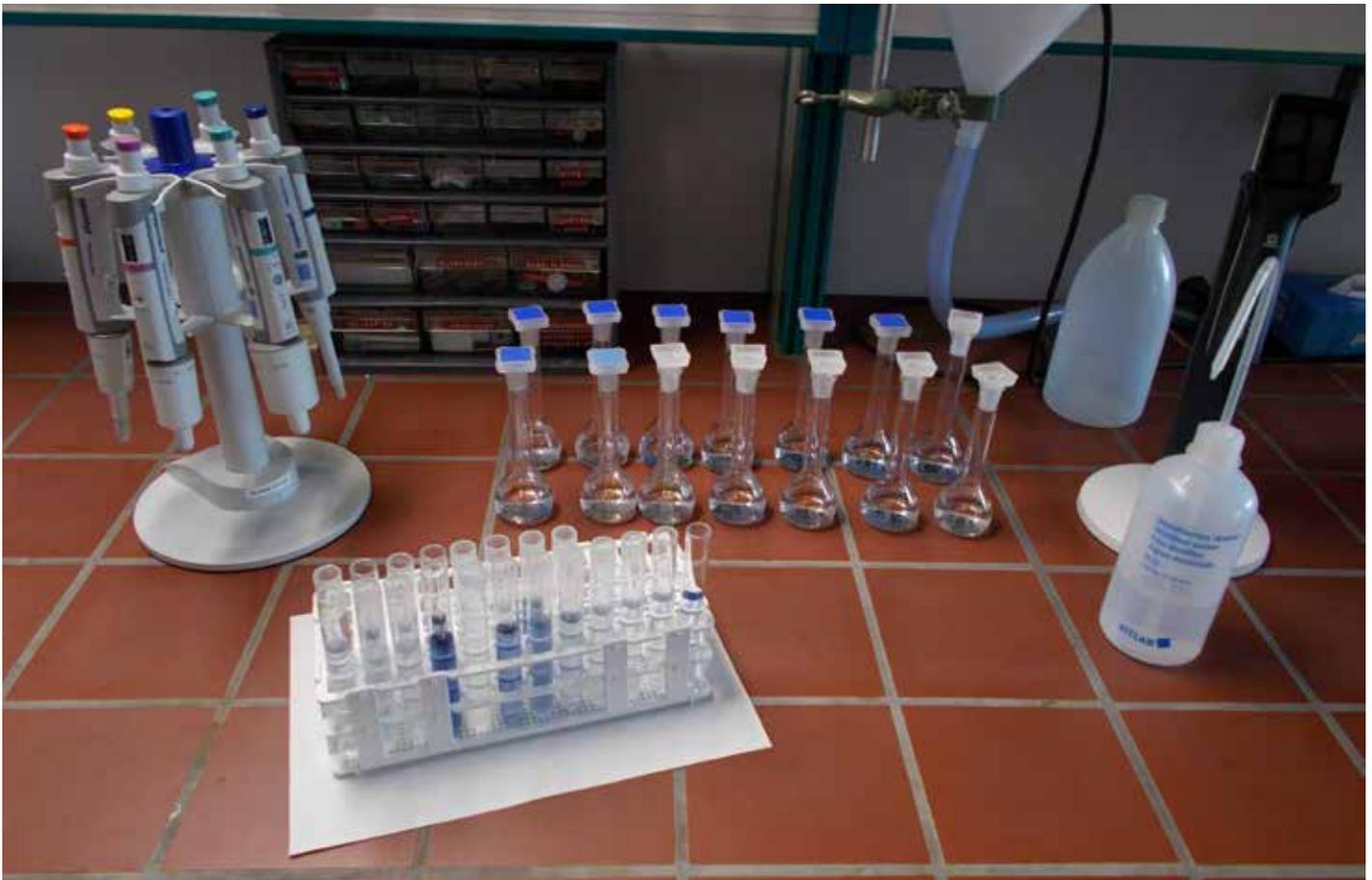
Abb. 1: Klassische Bestimmung von Phosphor mittels Photometrie (NLWKN)
