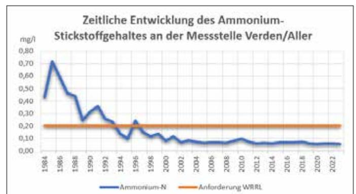
Abb 2: Zeitliche Entwicklung des Ammonium-Stickstoffgehaltes an der Messstelle Verden/Aller (NLWKN)
