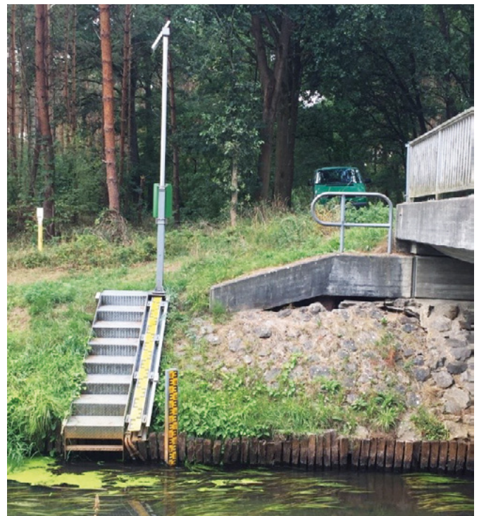
Gewässerkundliche Messstation (sog. „Kompaktstation“) mit zwei Pegelstapfeln (Senkrecht- und Schrägpegelatte) und Solarpanel zur Stromversorgung der Messtechnik.
