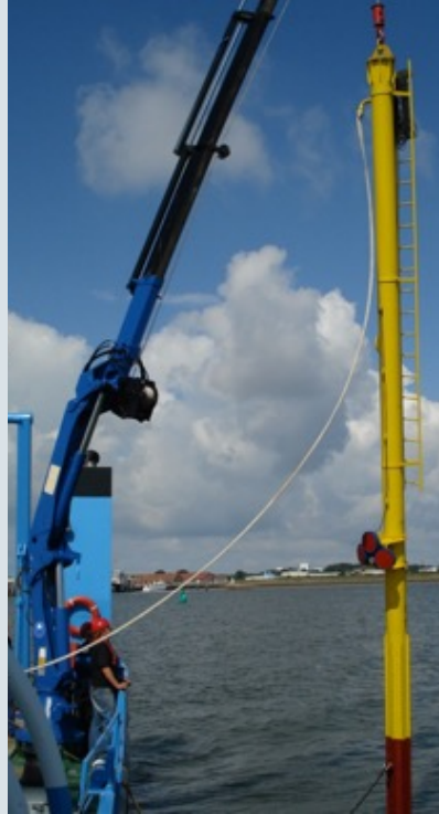
HADCP zur Erfassung der Strömung.
