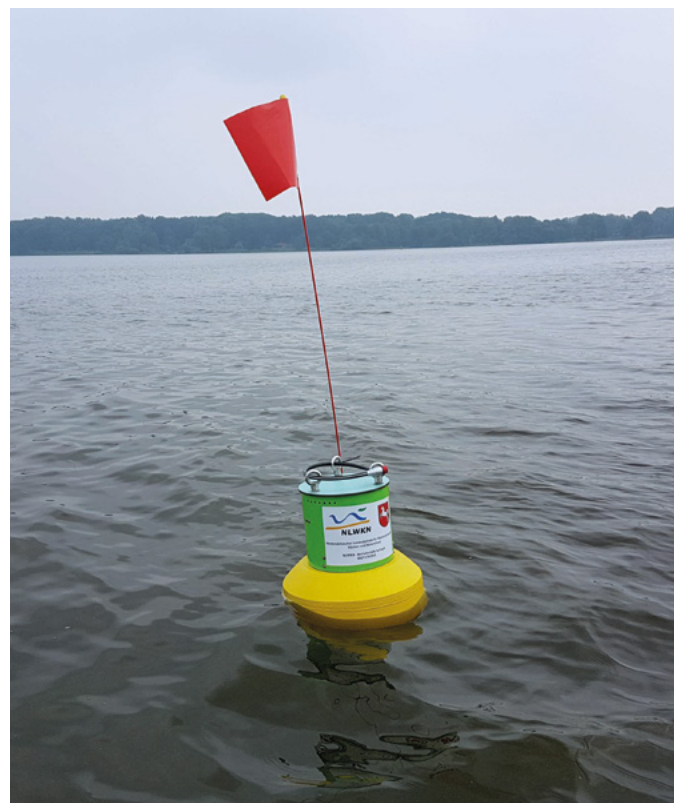
Gütemessboje zur Online-Überwachung der Gewässergüte.
