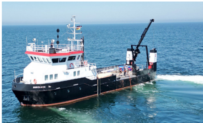
Das Forschungsschiff „Burchana“ des NLWKN hat eine sogenannte FerryBox, die kontinuierlich Gewässergütedaten wie Sauerstoff, Salzgehalt, Temperatur, pH-Wert, Schwebstoffgehalt, aber auch Nährstoffparameter und Chlorophyll messen kann.
