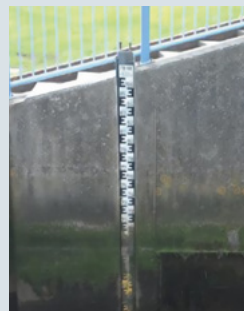
Pegelturm des Pegels Varel Schluise bei Flut.
