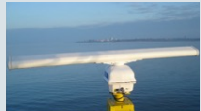
X-Band-Radar mit Fokus auf Seegangsausbreitung und Strömung im Norderneyer Riffgat.
