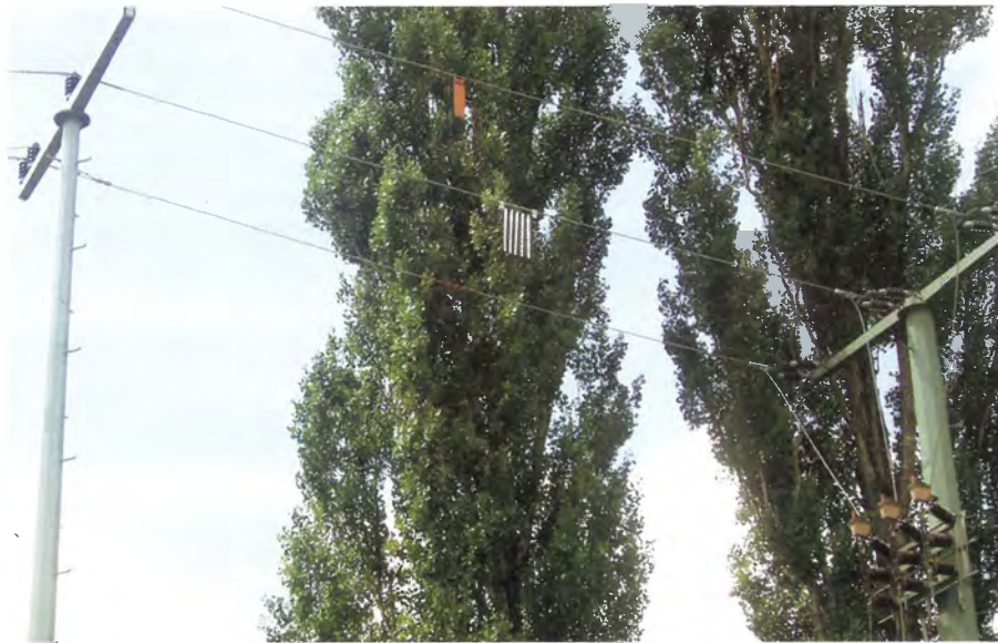
Abb. 13: Schwarz-Weiß-Markierung vor einem dunklen Hintergrund an einer Demonstrationsleitung. Die weißen Stäbe treten hervor, die schwarz-weiß-Markierung ist deutlich sichtbarer als die herkömmliche Markierung (rote Kunststoffahne).
