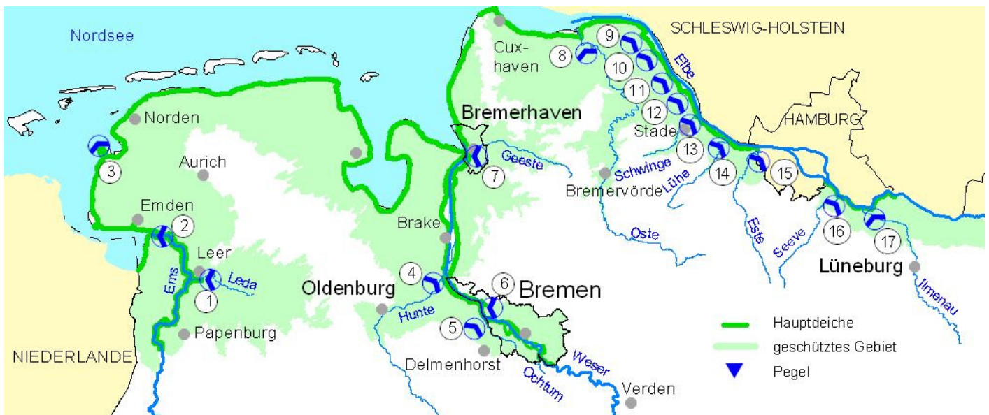
Abb. 5-4: Lage der Sperrwerke (Quelle: NLWKN, Auszug aus den Geobasisdaten der Niedersächsischen Vermessungs- und Katasterverwaltung)
