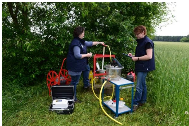
Abbildung 9: Grundwasserprobenahme im Gelände
