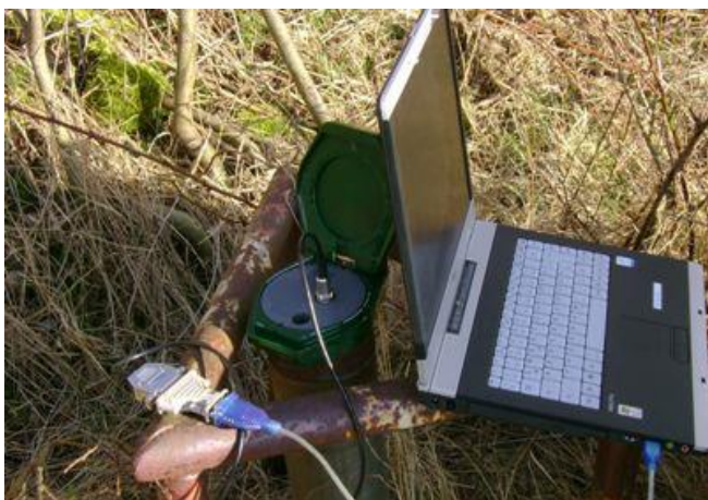
Abbildung 6: Auslesung eines Datenloggers im Gelände
