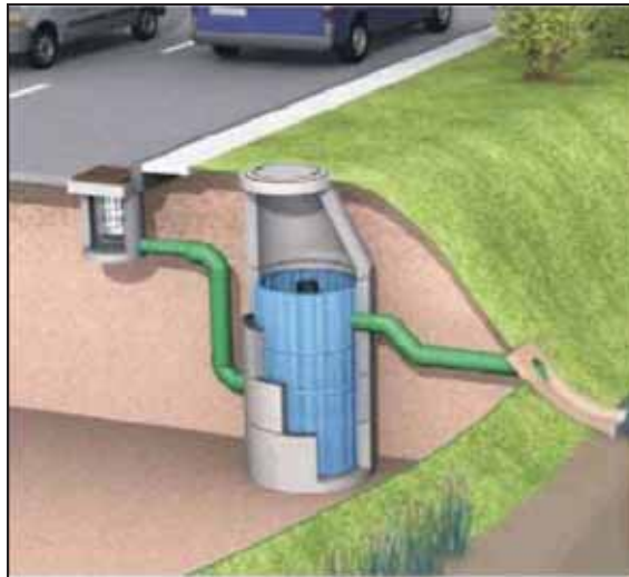
Funktionsschema eines HYDROCON-Filters an [Bildquelle: TEGGE, 2009]
