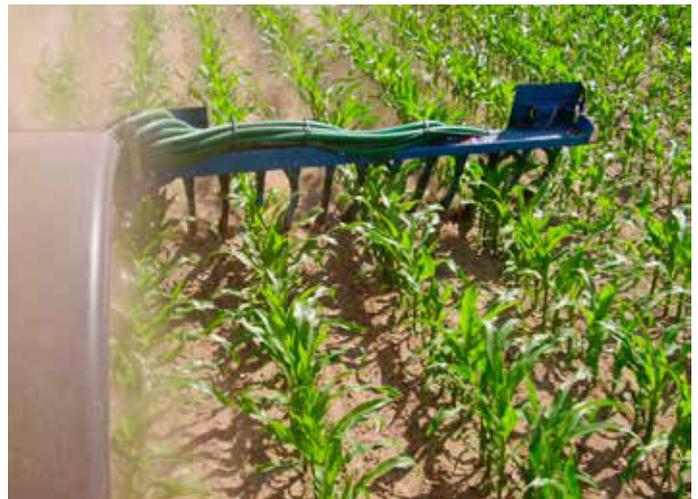
Abb. 77: Exakte bodennahe Ausbringung durch Schleppschuhverteiler (LWK Niedersachsen)
