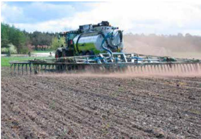
Abb. 76: Bodennahe Gülleausbringung durch Schleppschlauchverteiler (LWK Niedersachsen)
