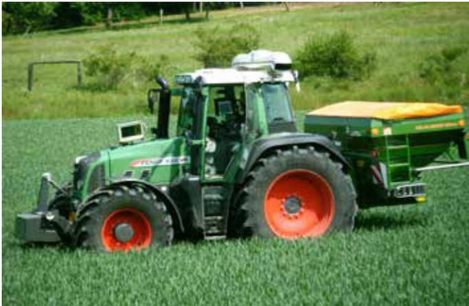
Abb. 110: N-Sensor (Online-Verfahren) zur Realisierung einer teilflächenspezifischen N-Düngung. (Geries Ingenieure GmbH)
