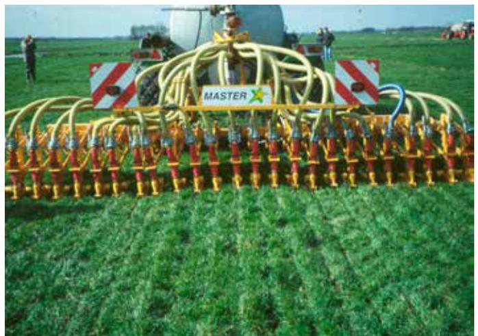
Abb. 78: Exakte Bodeninjektion durch Scheibenschlitzgerät auf Grünland (LWK Niedersachsen)
