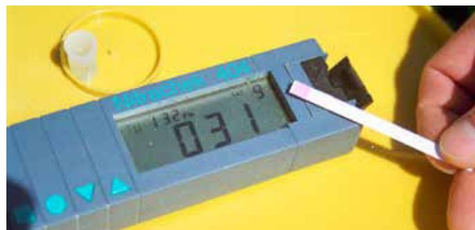
Abb. 25: Nitrachek-Gerät mit Teststreifen (INGUS)
