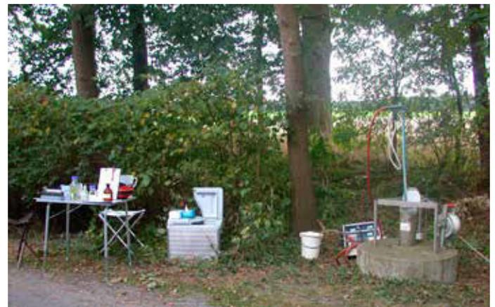
Abb. 164: Grundwasserbeprobung mit Unterwasserpumpe (NLWKN)
