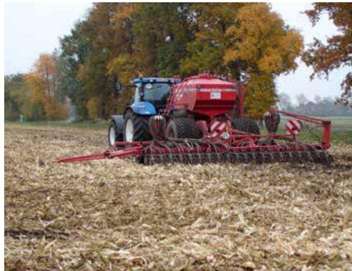
Abb. 67: Direktsaat von Winterroggen mit universeller Sämaschine; TGG Geeste-Varloh, Emsland (Schrader, LWK Niedersachsen)
