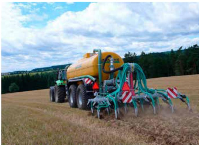
Abb. 79: Injektion und Einarbeitung in einem Arbeitsgang (LWK Niedersachsen)
