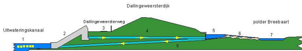
Abb. 22: Maßnahmen Breebaart. Links das Außengewässer (1), Schneckenpumpe (2), unter dem Deich liegendes Rohr (4), Entlastungsbecken (5), Fischtreppe (6), binnenseitiger Polder (7) temporär zu öffnender Durchlass (8) vom Becken zum Außengewässer.
